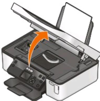
**Nota:** A cabeça de impressão move-se para a posição de instalação do tinteiro.
