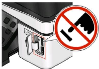
**Aviso: Danos potenciais:** Não toque em quaisquer cabos, em qualquer placa de rede, qualquer conector, dispositivo de memória ou na impressora nas áreas mostradas enquanto estiver a imprimir, ler ou escrever activamente a partir do dispositivo de memória. Poderá perder dados.
