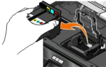
**Aviso: Danos potenciais:** Não toque no filtro de tinta da cabeça de impressão nem nos ejetores da cabeça de impressão.
